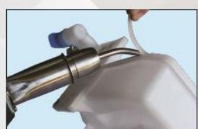
کاربرد الکترود جوشکاری نوع PE معمولاً در تانکرهای آب (سفید رنگ) و تانکرهای سوخت (مشکی رنگ) می‌باشد. هنگام کار روی محصولات آسیب دیده، ابتدا باید دمای جوشکاری را بسته به ضخامت قطعه آسیب دیده تنظیم کنیم. سپس در محل مورد نظر برای تعمیر، یک شیار ایجاد کرده و یک لایه جوش با الکترود نازک روی آن انجام می‌شود؛ سپس پلیسه یا زائدۀ‌های اطراف گرفته شده و یک لایه از الکترود ضخیم روی کار نهایی جوش می‌خورد.
