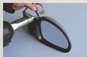
ABS پلاستیک بسیار سختی است که عموماً در خودروها و موتورسیکلت‌ها بکار می‌رود. پلاستیک‌های بکار رفته در سپر ماشین، محفظه آینه‌ها، جلو پنجره، چراغ ترمزهای عقب و بادگیرها و فلاپ‌های موتورسیکلت‌ها توسط این الکترودها جوشکاری می‌شوند.
